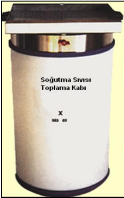
Resim 5.7: Örnek soğutma sıvılarını toplama kabı ,Kaynak: Waechter Firması
